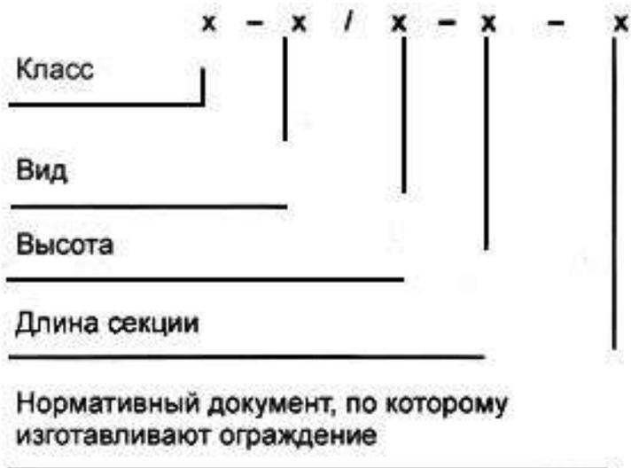
**Пример обозначения основной части маркировки пешеходного и защитного ограждения: УПО-Д обозначает, что ограждение удерживающее пешеходное (УПО), дорожное (Д).**
